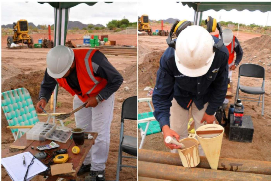
Foto 1: Muestreo y resguardo de la muestra, control de viscosidad del lodo de perforación.
